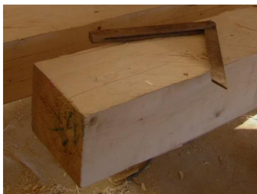
Obr. 40 a) Pokosník, b) značkovací šňůra s hlinkou
