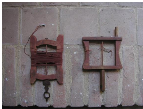
Obr. 40 a) Pokosník, b) značkovací šňůra s hlinkou
