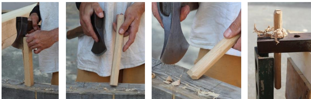
Obr. 15 Postup výroby kolíků
