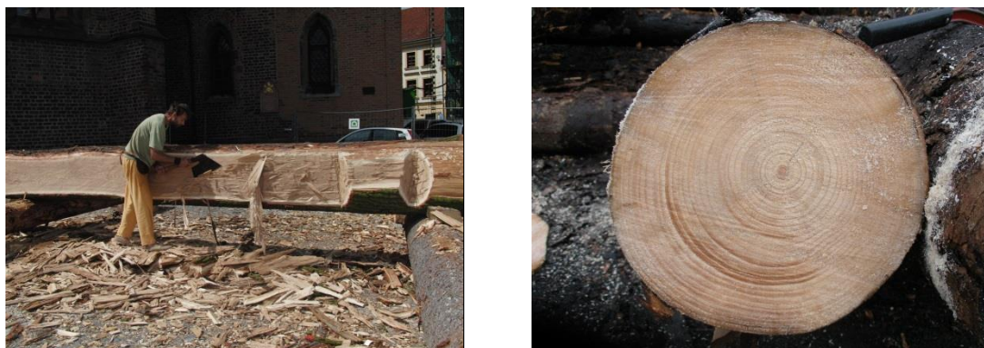
Obr. 42 a) Lícování, b) tlakové dřevo smrku
