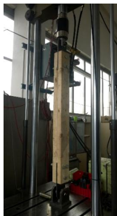
Obr. 1 Zkouška spoje v tahu (vlevo) a výsledky tahových zkoušek (vpravo)
