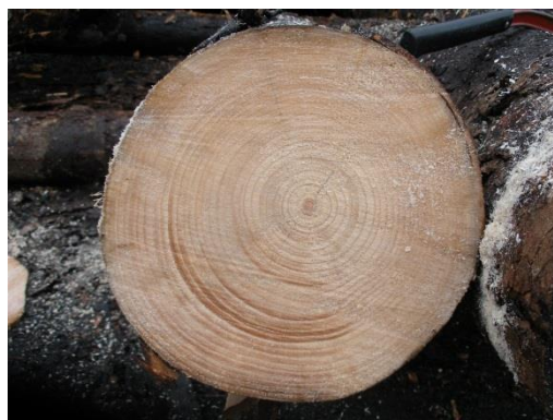
Obr. 74 Lícování (vlevo), tlakové dřevo smrku (vpravo)
