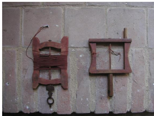
Obr. 72 Pokosník (vlevo), značkovací šňůra s hlinkou (vpravo)
