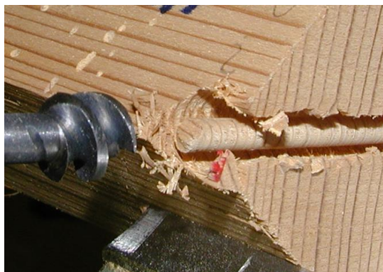
Obr. 14 Detail odběru vzorku válcového tvaru
