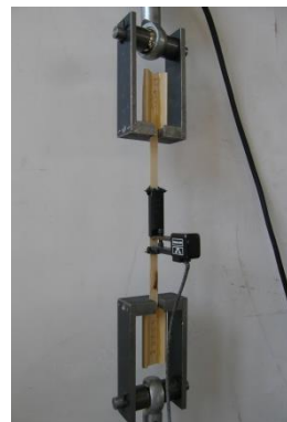
Obr. 17 Tahová zkouška trojúhelníkové lišty
