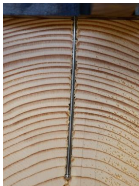
Obr. 12 Detail průniku trnu materiálem
