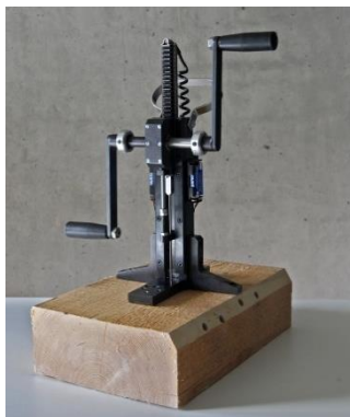
Obr. 11 Přístroj pro měření mechanického odporu dřeva při zatlačování trnu
