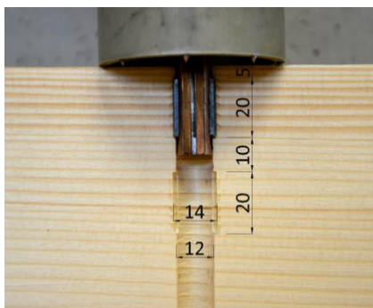
Obr. 18 Detail tábla s rozevřacím klínem a zakulacenými čelistmi
