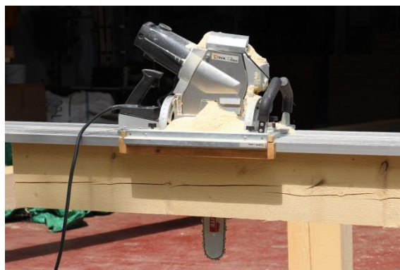
Obr. 35 Řezání podélného plátu pomocí tesařské řetězové pily
