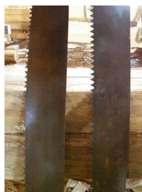
Obr. 71 Tažný plát pily pro podélné řezání (vlevo), tažný plát pily pro příčné řezání (vpravo)
