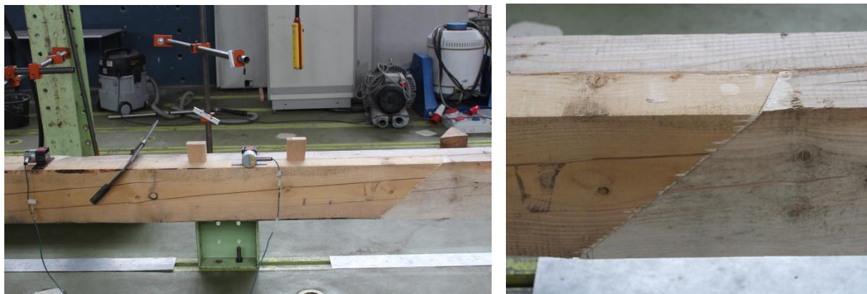
Obr. 2: a) Použití spoje během experimentu – zkoušky v třibodovém ohybu; b) detail šikmého podkoseného čela
