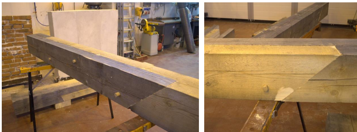
Obr. 3: a) Celkový pohled na funkční; b) detail šikmého čela a jednoho dřevěného kolíku
