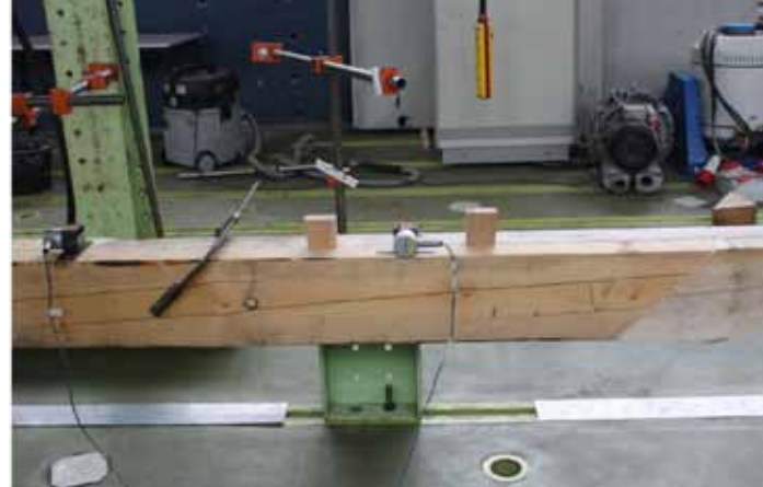
▲ Obr. 9. Funkční vzorek dvouhmoždíkového spoje s šikmými čely a podkosenou šikou: a) rozměry, b) během experimentu
